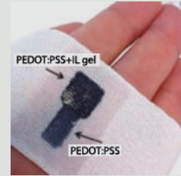
L'objectif n'étant plus de peindre un motif sur un kimono mais de **rendre une partie d'une étoffe conductrice**, le colorant a été remplacé par un **polymère organique conducteur : le PEDOT:PSS**. Pour l'appliquer, il est nécessaire de réaliser un pochoir. Un film de polyamide est découpé au laser pour former une bordure du motif voulu qui servira d'électrode.
